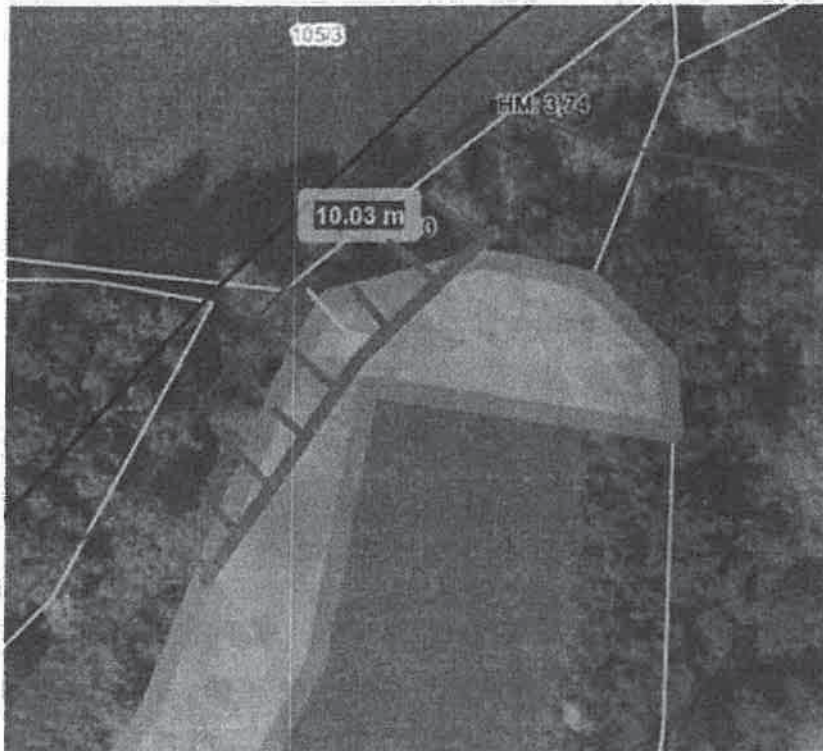
Ausschnitt gerinnenaher Bereich im Nordwesten des Grundstücks 109/1, welcher aus Sicht der Wildbach- und Lawinerverbauung für eine höherwertig Nutzung nicht geeignet sind, mit skizzierten SAPRO Abstand (10m) und Geländeböschung.
