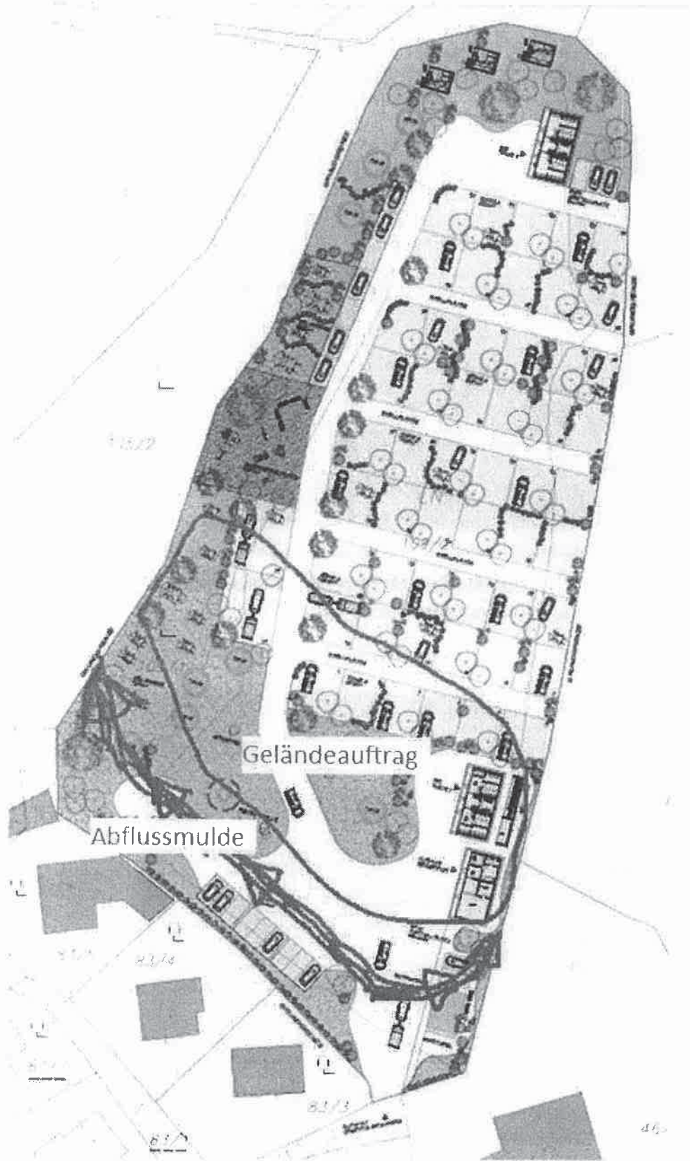
Konzept Übersichts-Lageplan „Camping Gipswiese“ mit rot skizzierten Schutzmaßnahmen
